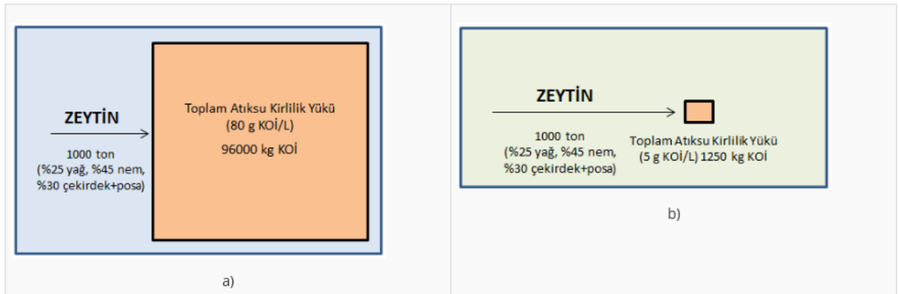
Şekil 6. Zeytinyağı üretim proseslerinde oluşan atıksu kirlilik yükleri
